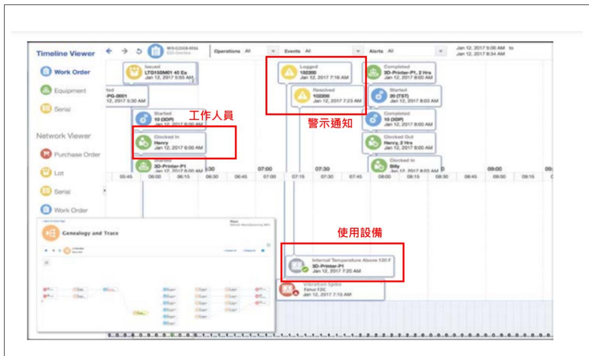
圖七、MES 利用 AI 追蹤訂單的生產環節，如工作人員、機台使用狀況
