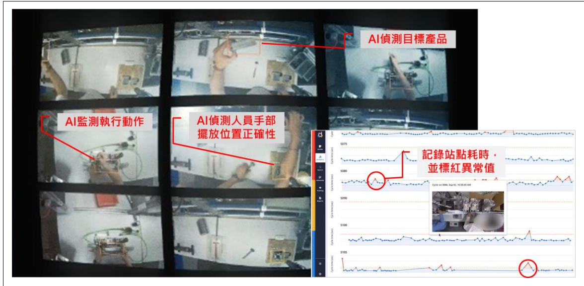
圖二、MES 加入 AI 自動辨識人員動作以改善人員生產力
